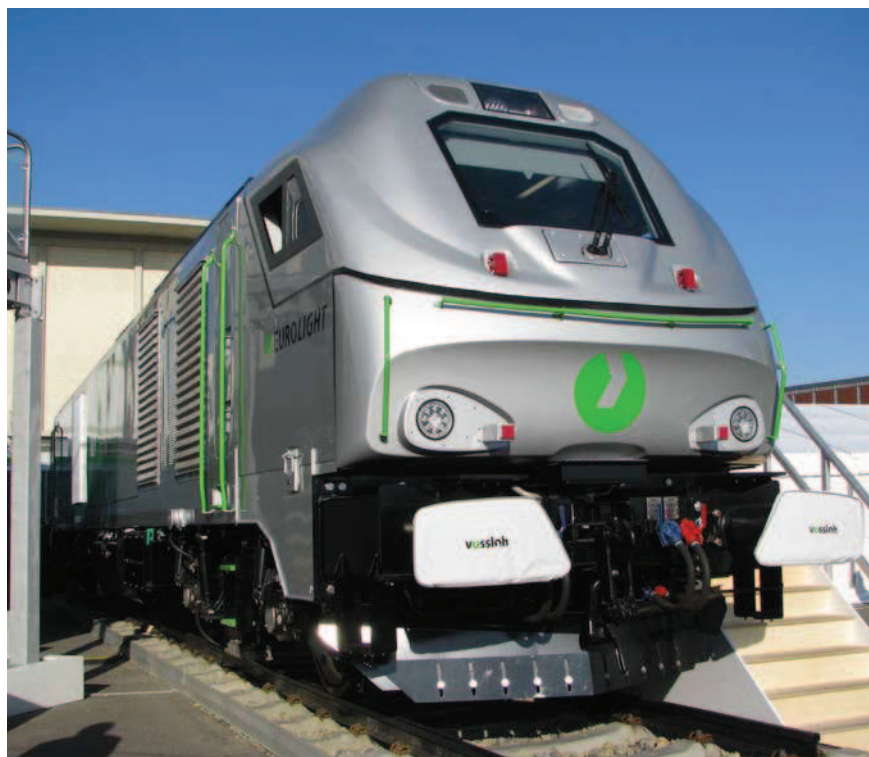
Locomotora Vossloh EUROLIGHT de bajo peso por eje.
